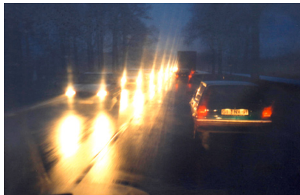
Schmutzige Scheinwerfer blenden den Gegenverkehr und erhöhen so das Unfallrisiko. Quelle: © Hella KGaA Hueck & Co. 2004
