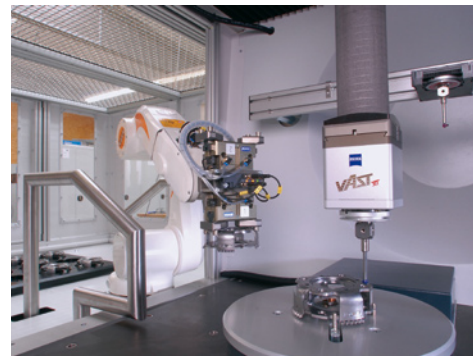
RoboMax mit dem Koordinatenmessgerät GageMax und einem Industrieroboter als Zuführsystem. Quelle: Carl Zeiss Industrielle Messtechnik GmbH
